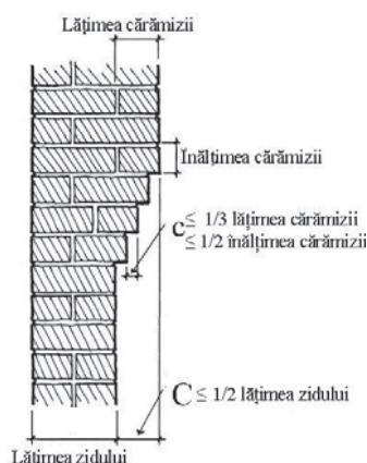
Figura C 10.11. Zidirea cornișelor și brâurilor
