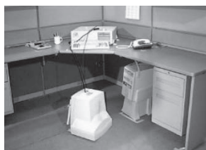
Figura C 10.50. Testarea stabilității și prinderilor pentru calculatoarele personale
